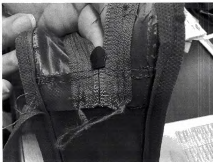
Falta de acabamento: Zíper desfiando - Acabamento interno
