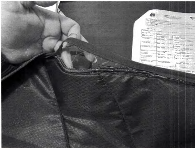
Falha na costura: Costura solta, torta e duplicada – Acabamento interno
