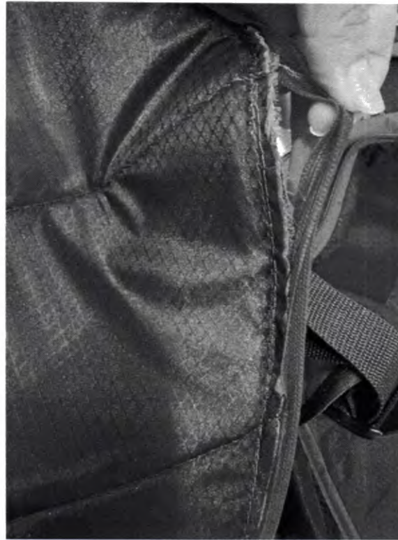
Falha de acabamento: Costura falha, torta – Acabamento interno
