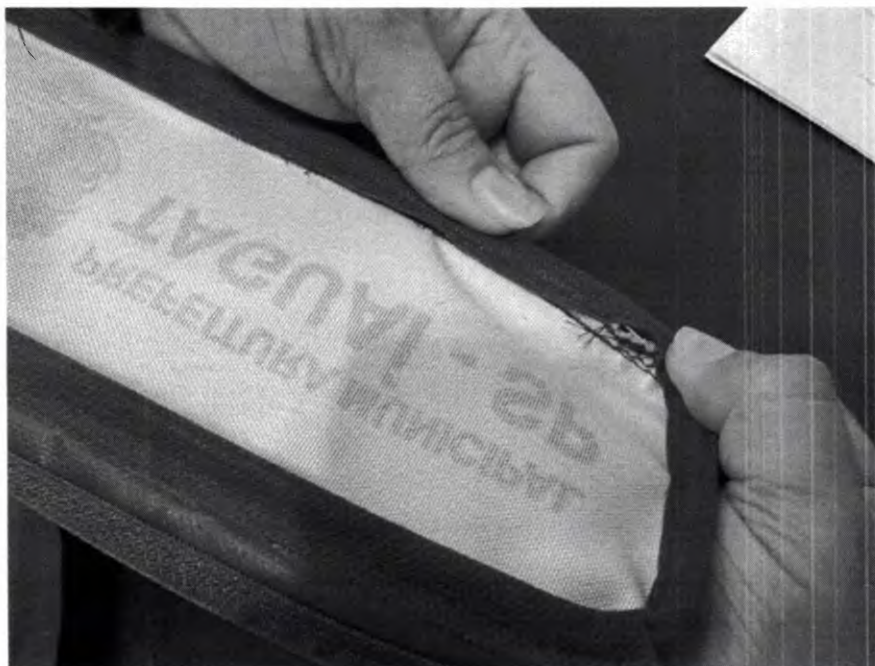
Falta de acabamento – Costura solta, embolada – acabamento interno
