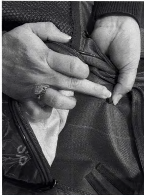
Falta de acabamento: Falta de arremate do galão - Acabamento interno
