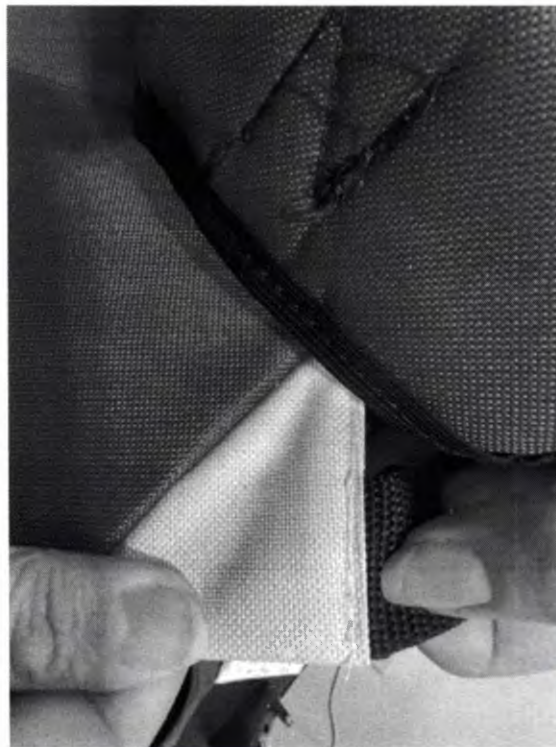
Falta de acabamento: costuras emboladas - Acabamento externo
