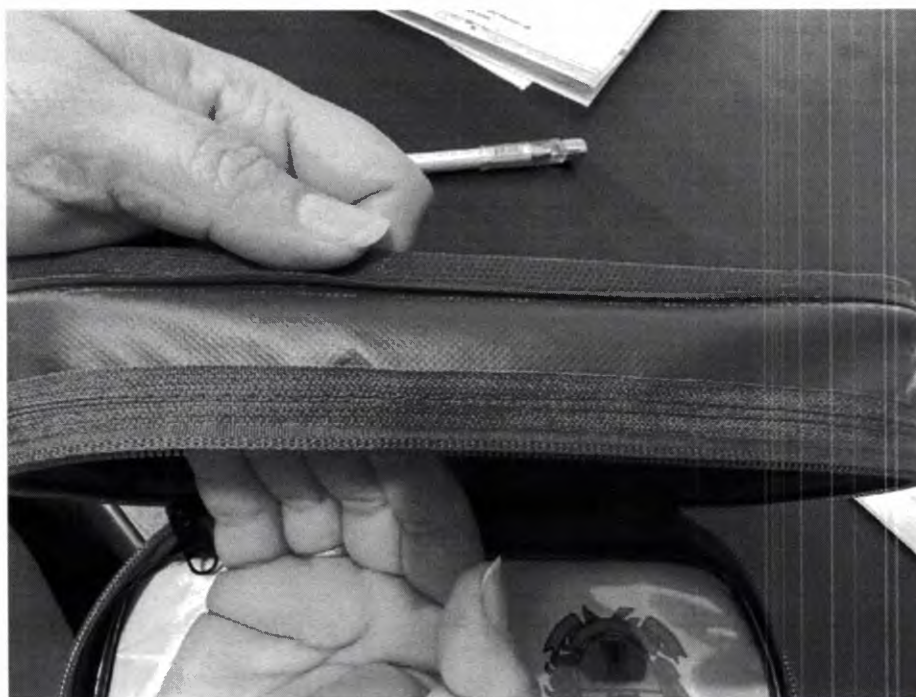
Falta de acabamento – Costura torta e assimétrica – acabamento interno
