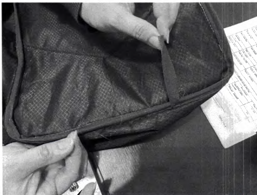
Falha na costura: Falta de arremate – Acabamento interno
