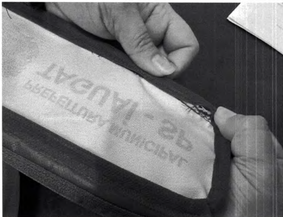
Falta de acabamento – Costura solta, embolada, falta de arremate – acabamento interno
