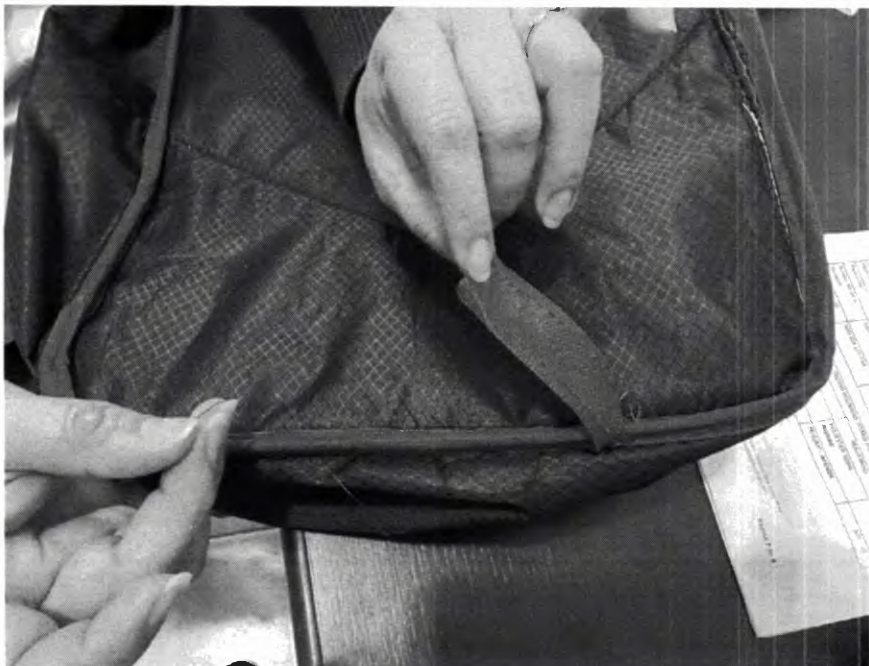
Falha na costura: Costura solta-se facilmente – Acabamento interno
