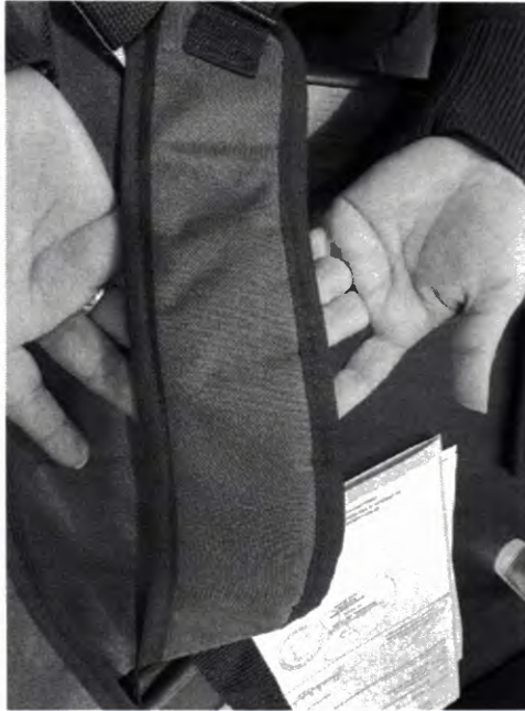
Falha de acabamento: costuras assimétricas – Acabamento externo
