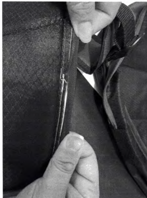
Falha de acabamento: Costura duplicada e embolada – Acabamento interno
