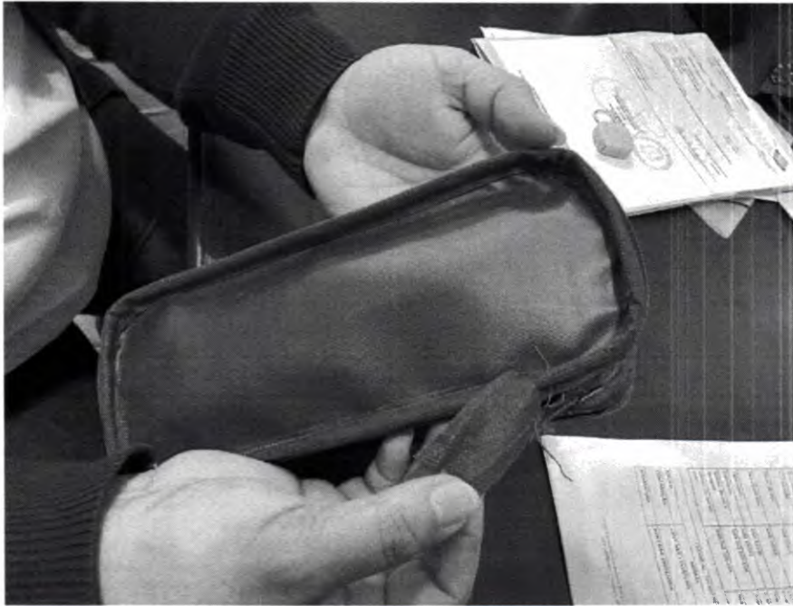
Falta de acabamento: Falta arremate, a costura solta-se facilmente e a cor do acabamento diverge da principal que é azul marinho - Acabamento interno
