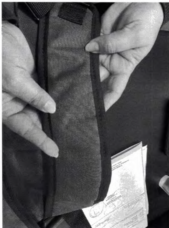
Falta de acabamento: costuras assimétricas - Acabamento externo
