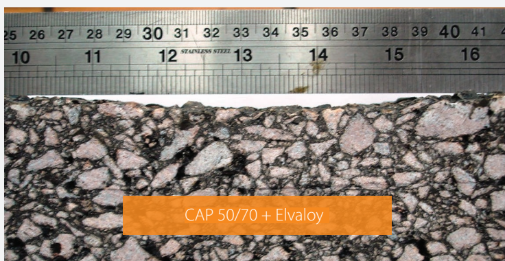
Figura 3: Foto da deformação permanente da mistura com CAP 50/70 (REVAP) + 1,2% de Elvaloy.
