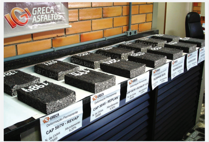
Figura 8: Placas após o ensaio de deformação.
